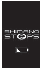
Batteriniveau for lavt
